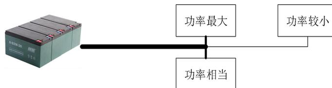
3.2.2.2 当大功率设备安装位置分散时，建议采用串联链式接法配线工艺，设备功率越大的越靠近电池，如下图所示：
