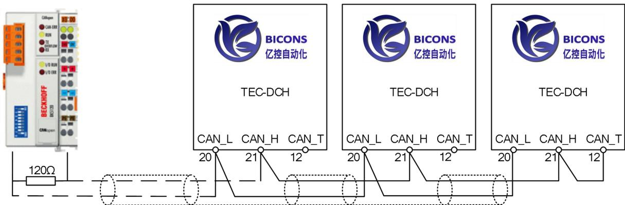
3.2.2 在大多数系统中，电力电缆上的电流可以达到几十甚至几百安培，而信号处理设备的电流仅几安培甚至只有数十毫安。这种情况下，因为电力电缆有一定的电阻，所以电力电缆上会产生压降，当电位差较大时，会导致大功率设备与小功率设备之间的信号地不等电位，这样会引起CAN总线上的数据传输错误。如果系统中设备的功率悬殊很大时，为尽量减小参考地的电位差，建议配线工艺按如下所示进行优化。
